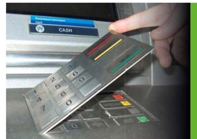
Mecanismo por el cual los delincuentes montan piezas falsas que simulan ser auténticas con la finalidad de obtener los datos y clave de la tarjeta. Las piezas se montan sobre las piezas originales de los cajeros y estas pueden ser:
